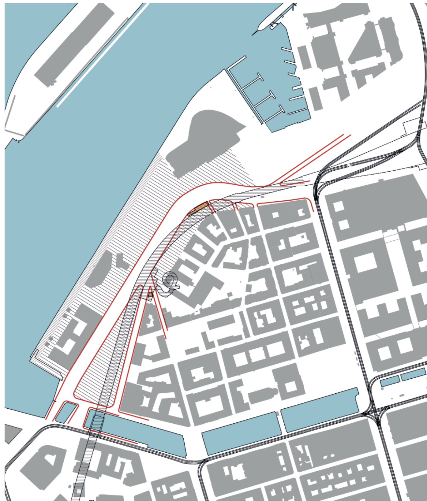
Huvudstruktur - gång-, cykel och kollektivtrafik leds över den yttre bron. Biltrafik leds över den inre.
